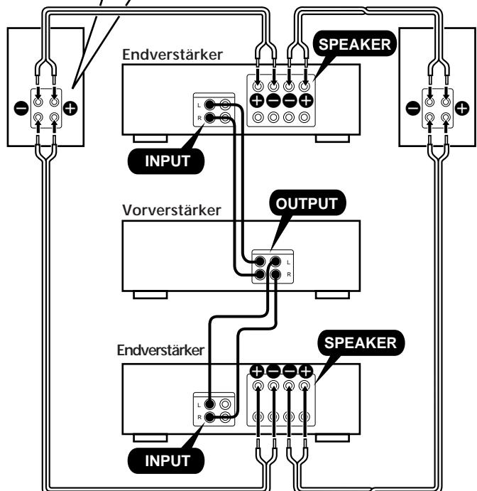
Durch einen Streifen ö.ä. gekennzeichnete Leitung an „+“ anschließen.
